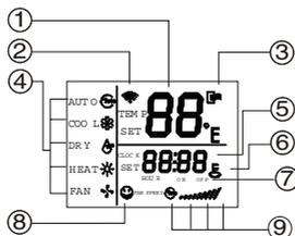
1. Индикатор температуры (TEMP): Показывает установленную температуру во всех режимах кроме режима вентиляции (FAN). Для изменения установок используются кнопки увеличения температуры (ADJUST▲) и уменьшения температуры (ADJUST▼).
